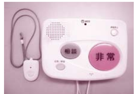
緊急通報システム装置
