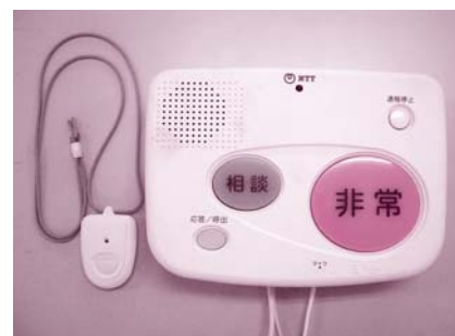
緊急通報装置システム
