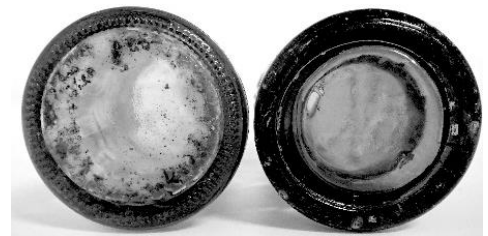
【図 2】ナーリング加工を持つ資料(左)と持たない資料(右)
