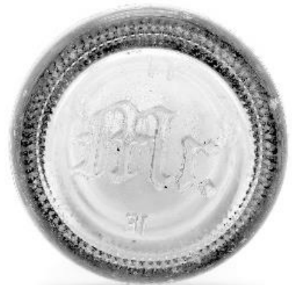
【図 13】底面にナーリング加工があるタイプ
